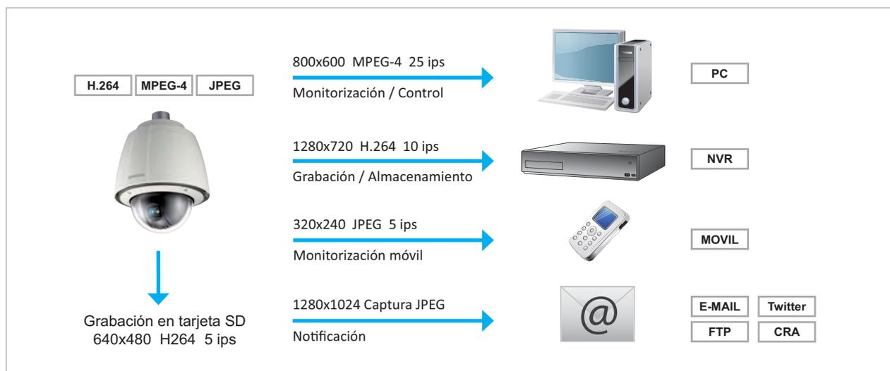
El ejemplo muestra cómo una buena gestión de los flujos de vídeo (streams) puede ayudar a optimizar el ancho de banda de la red y la capacidad de almacenamiento del sistema.
